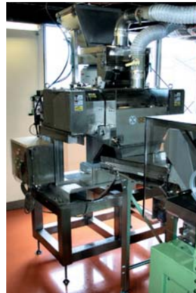
De LenaStar ontdoet voedingsmiddelen in twee fasen van metaalbesmetting.
