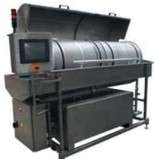
De trommelfilter filtert het vuil uit het water zonder de productie te hoeven onderbreken.
