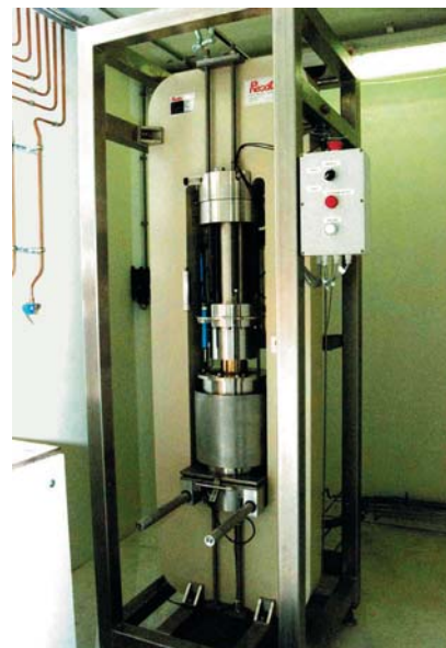
Hogedrukapparatuur opgesteld bij A&F voor het op kleine schaal steriliseren van levensmiddelen, ontwikkeld binnen het EET-project.
