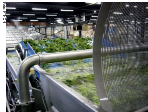
Een bestaand flotatiewassersysteem van FTNON.
