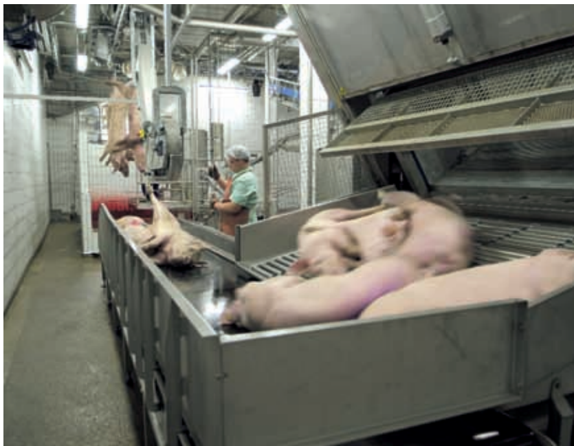
Bij het welzijnsvriendelijk verdoven met CO 2 gaan de groepen varkens door een bed van CO 2 en komen daarna op een band die ze naar de slachtlijn voert.
