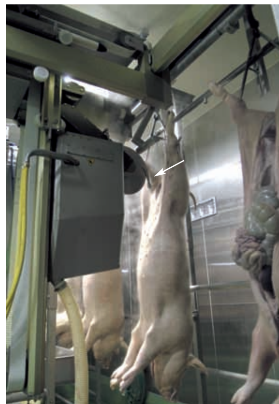
Automatische buikenopener waarbij een vinger (zie pijl) de buikwand naar voren trekt zodat bij het doorsnijden van de buikwand het darmpakket minder vaak wordt beschadigd.
