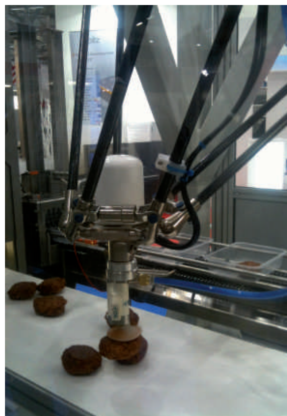
Producten die kriskras door elkaar op een band liggen worden opgepakt door de robot van Kawasaki.
