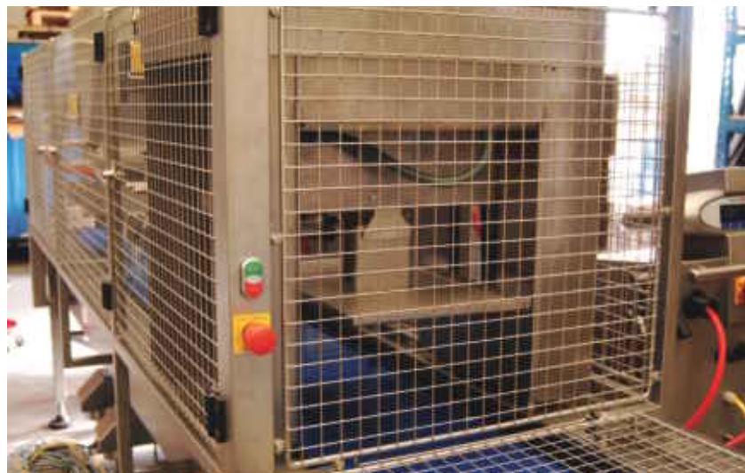
Een door Bakon gebouwde machine met noodstop van Pilz.
