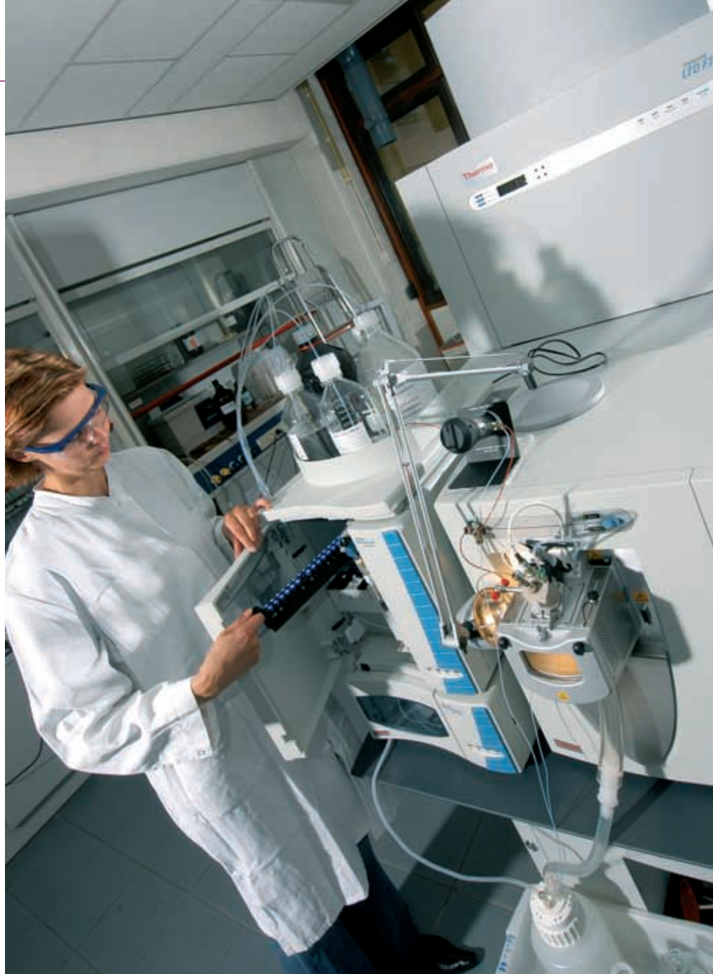
De voorbewerkte monsters worden gemeten door middel van GC-MS en LC-MS analyse.
