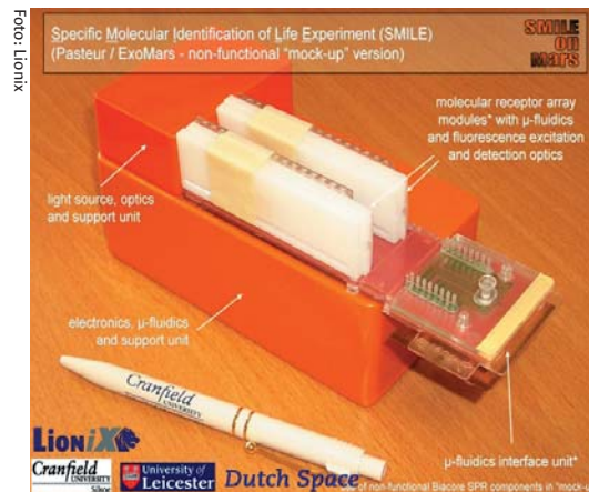
Een mock-up LOC-systeem voor Mars van Lionix.
