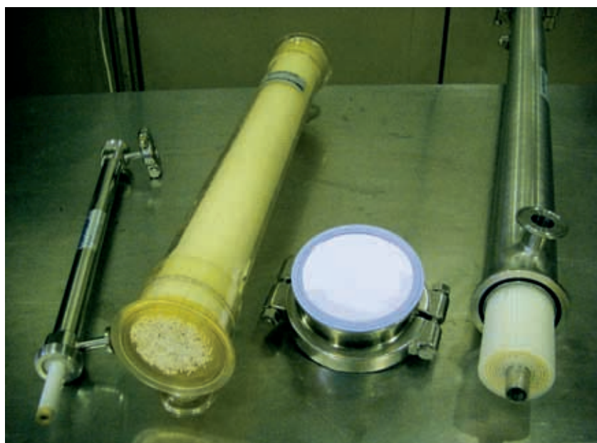
Een overzicht van verschillende uitvoeringsvormen van membranen, die in de mini-membraanunit getest kunnen worden; v.l.n.r. keramiek, capillair, vlakke plaat en spiraal gewonden membranen.
