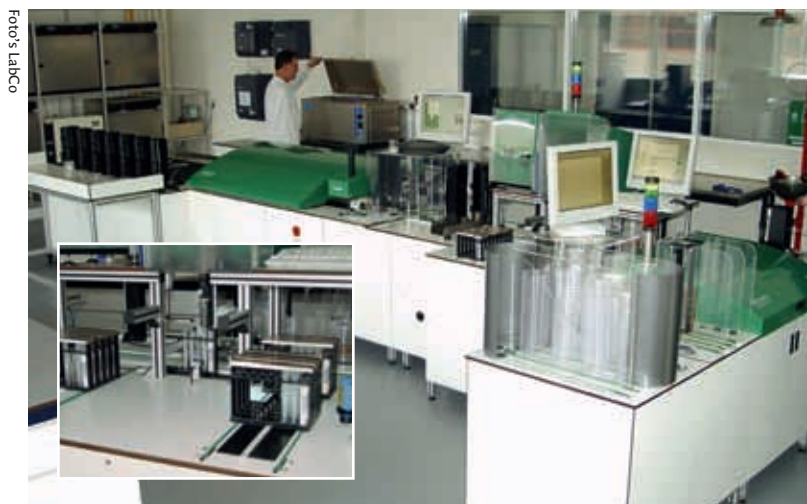
Straat voor geautomatiseerde microbiologische bepalingen in het laboratorium van LabCo. Inzet: pipetteerautomaat.
