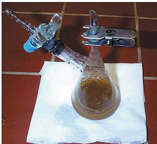
Fig. 6 Incubatievatje met pensinoculum voor de in vitro studie van methaanproductie, vezelafbraak en lipolyse en hydrogenatie van vetzuren.
